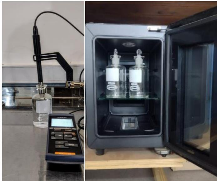
Fig. 7: Oxímetro Portátil (izquierda); Incubadora DBO (derecha)
