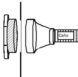
Para las conexiones de los caños hacia las cajas siempre se deben utilizar conectores y deben estar colocados correctamente
