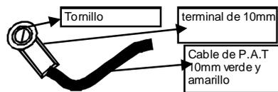
los cables de puesta a tierra siempre deben estar sujetas a las cajas mediante terminales.
